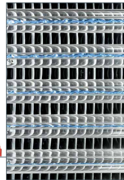
Évaporateur avec fluide frigorigène en circulation
