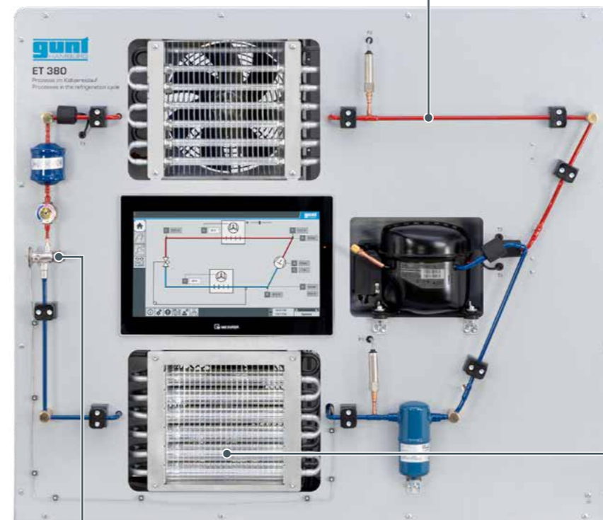
Le processus circulaire se reflète dans la tuyauterie et sur l'écran tactile
