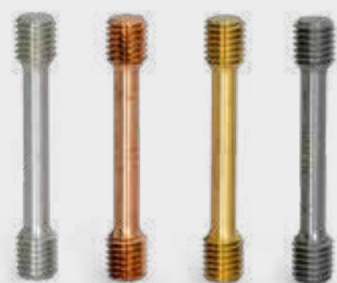
Éprouvettes de traction à coupe transversale circulaire selon DIN 50125, matériau: Al, Cu, acier, CuZn
