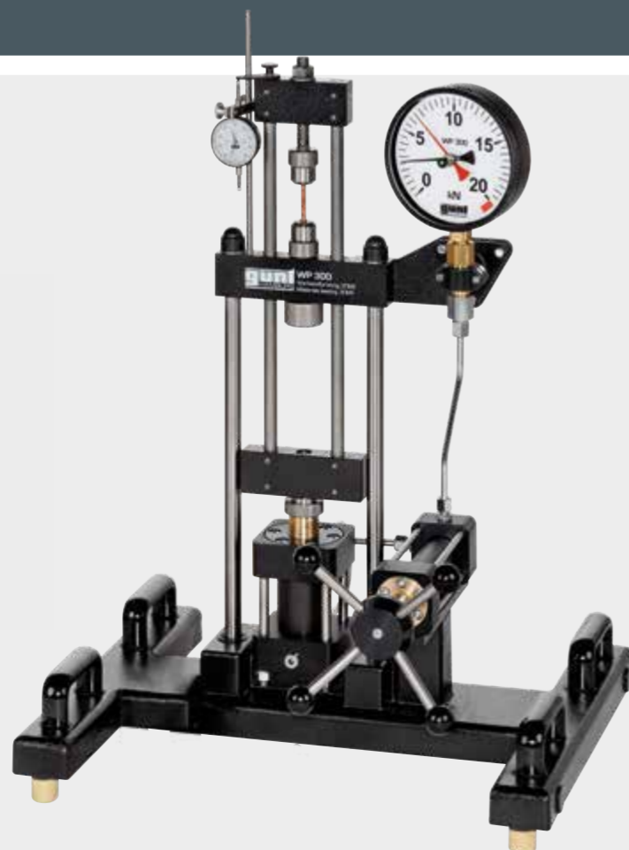
Éprouvettes de traction à coupe transversale circulaire selon DIN 50125, matériau: Al, Cu, acier, CuZn
