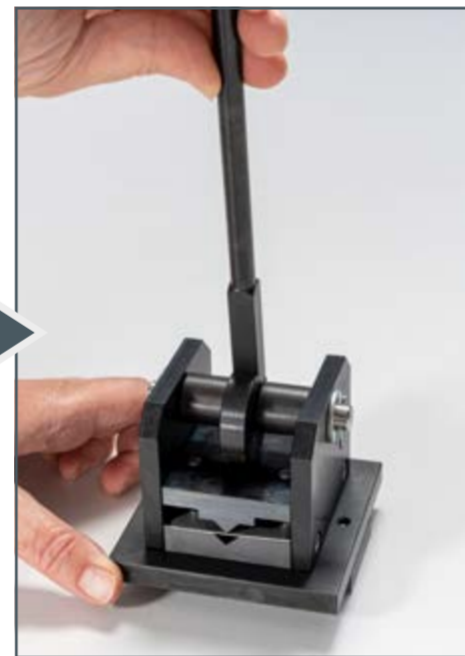
Formage d'une pièce d'usinage avec la presse de pliage du TZ 200.01
