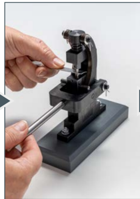
Perçage de trous avec la presse à levier du TZ 300
