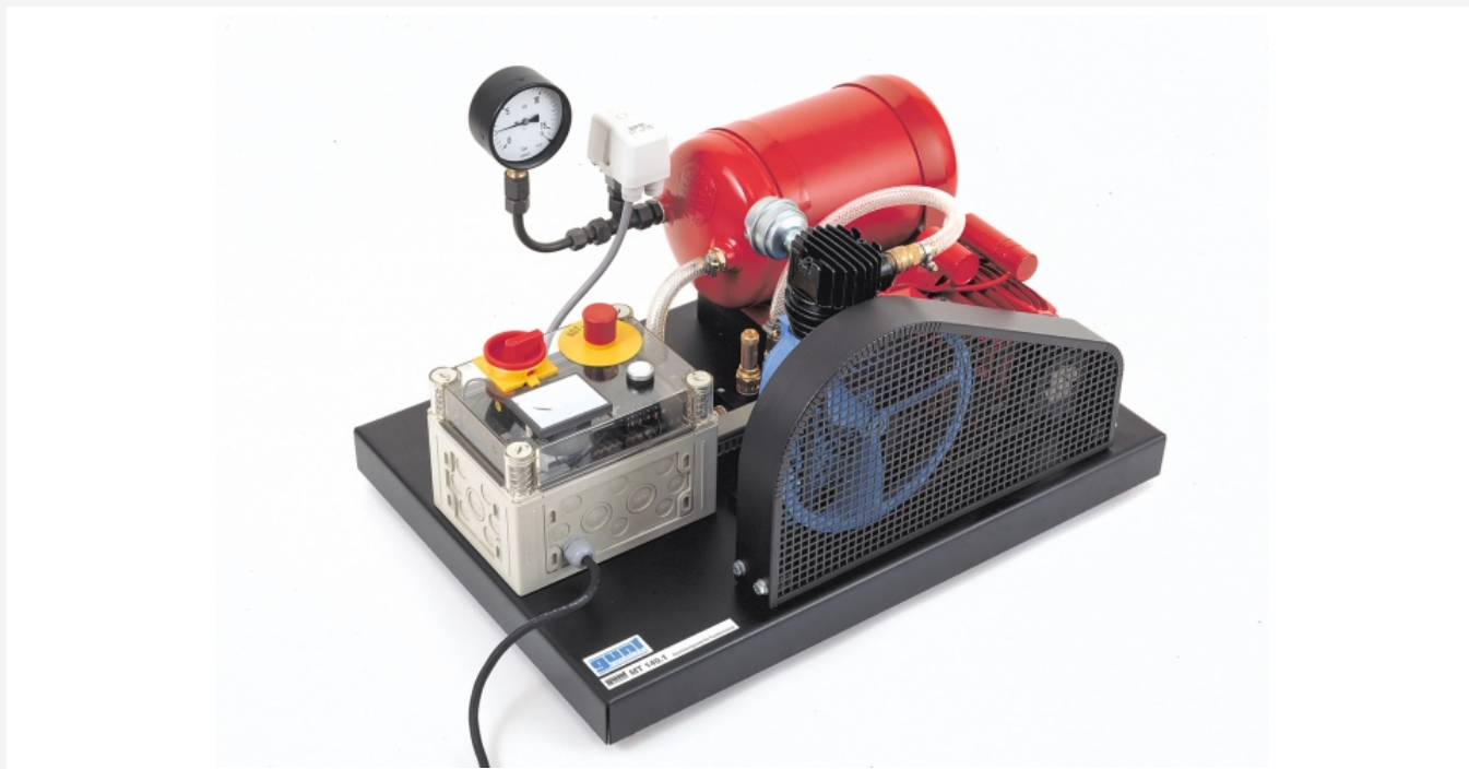
L'illustration montre le dispositif MT 140.01 avec le compresseur MT 140 ou MT 140.02 à contrôler.
