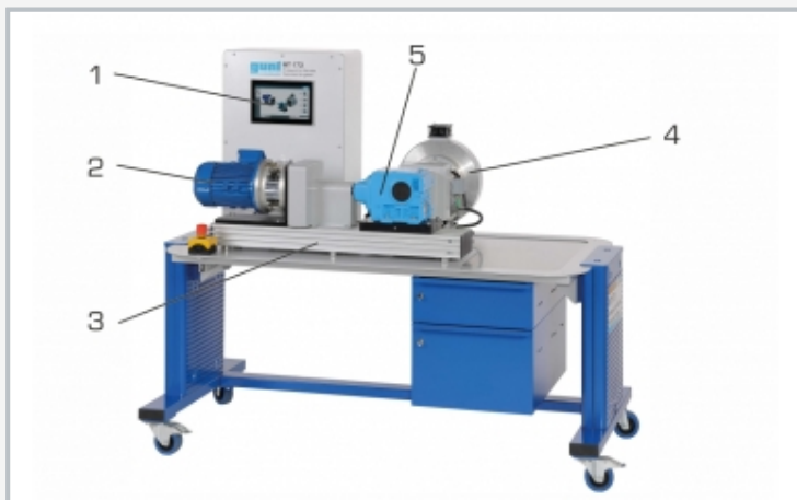
1 écran tactile pour le fonctionnement, 2 moteur d'entraînement, 3 plaque de base pour accueillir le moteur et l'engrenage, 4 frein, pivotant, 5 MT 123 Engrenage droit et à vis sans fin
