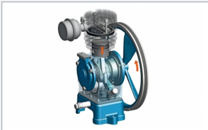
Aperçu transparent du compresseur à piston monté (capture d'écran de la vidéo de montage)
