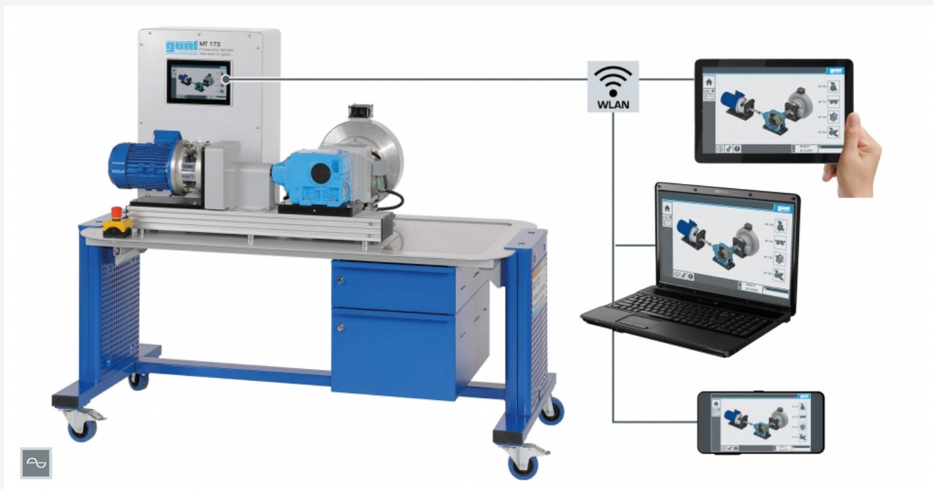
L'illustration montre MT 173 avec MT 123 Engrenage droit et à vis sans fin. Possibilité de „screen mirroring” sur nombreux terminaux.
