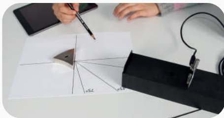
LP5.1.3.1 Réflexion sur un miroir plan
