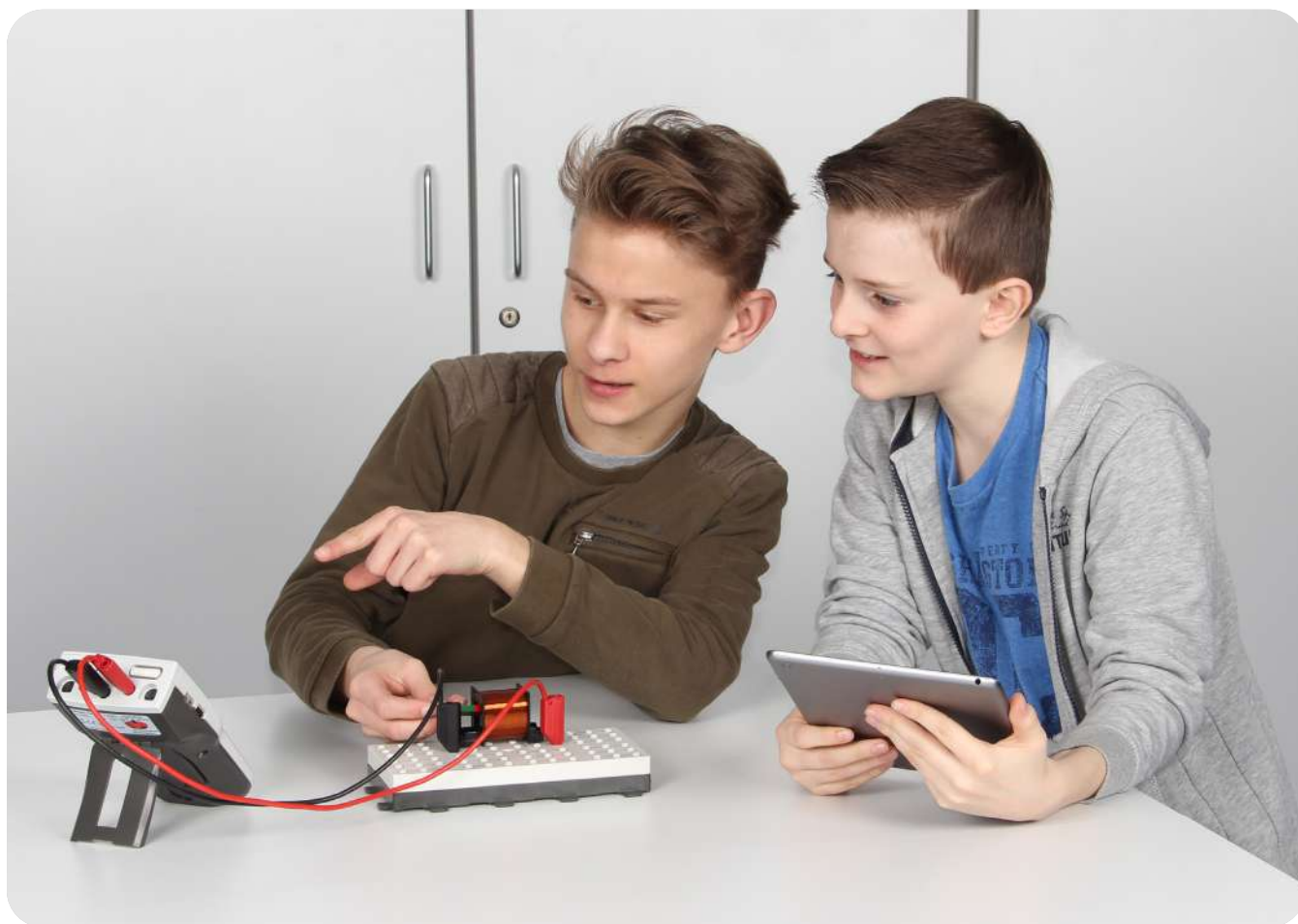
LP3.4.3.1C Induction électromagnétique avec aimant droit et bobine
