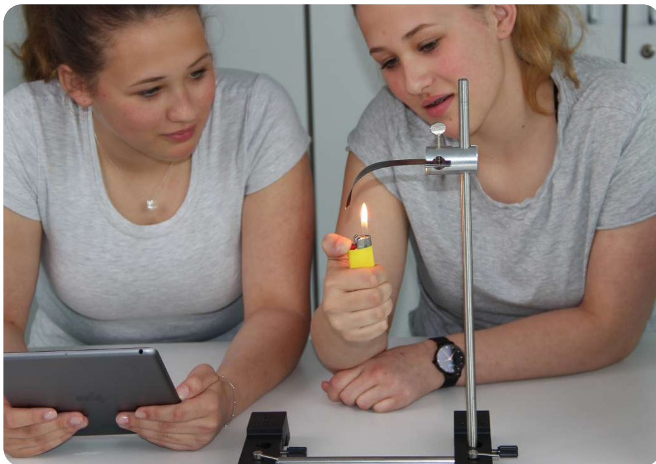
LP2.1.1.4 Propriétés thermiques d'un bilame
