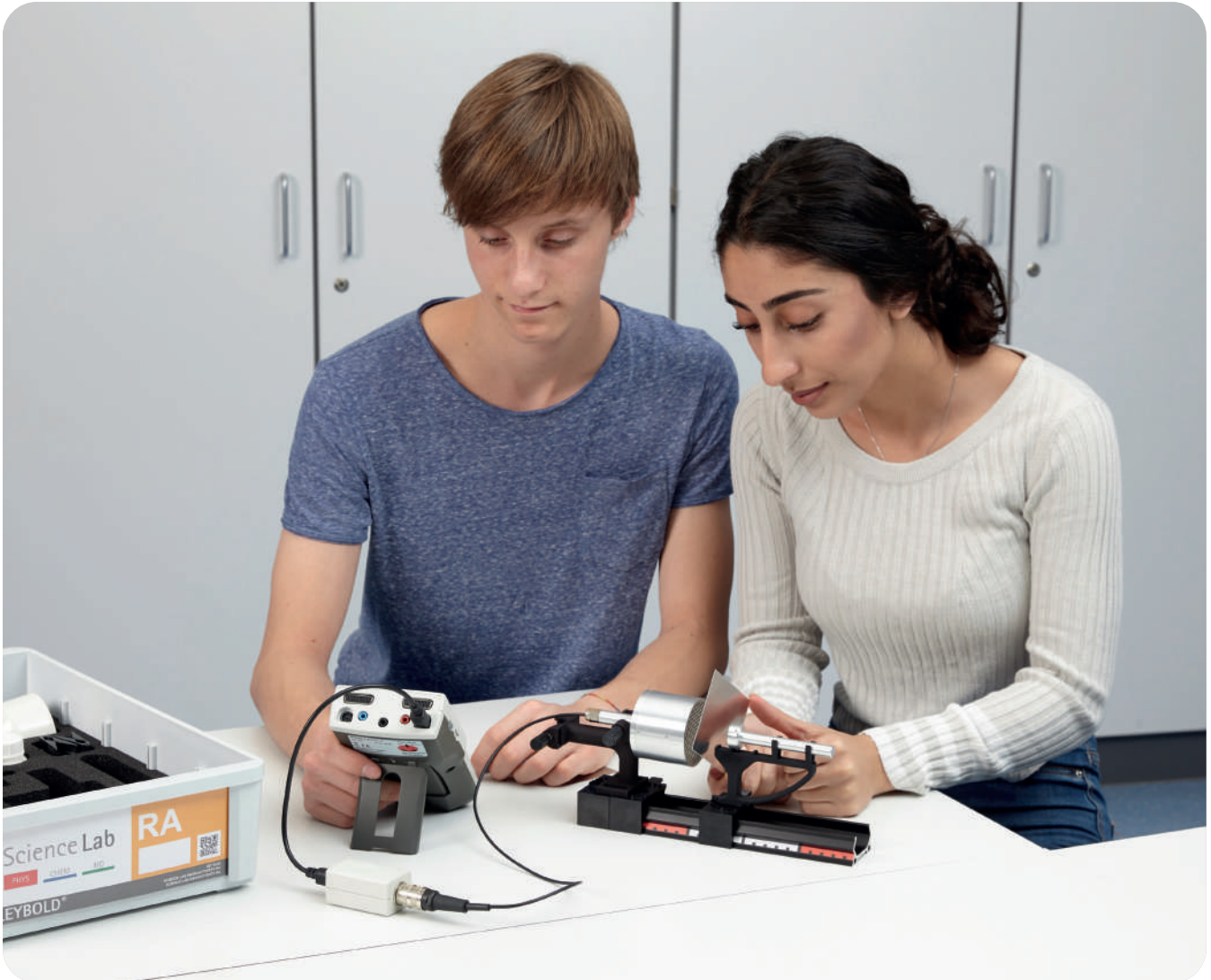
LP6.2.1.3C Mise en évidence du rayonnement radioactif dans une source en forme de bouton
