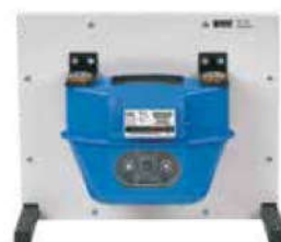
VS 105 Modèle en coupe: compteur à gaz
