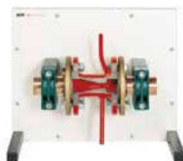
HM 700.03 Modèle en coupe: Venturimètre normalisé
