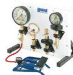
HM 700.16 Modèle en coupe: manomètres
