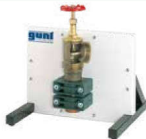
HM 700.05 Modèle en coupe: soupape d'équerre
