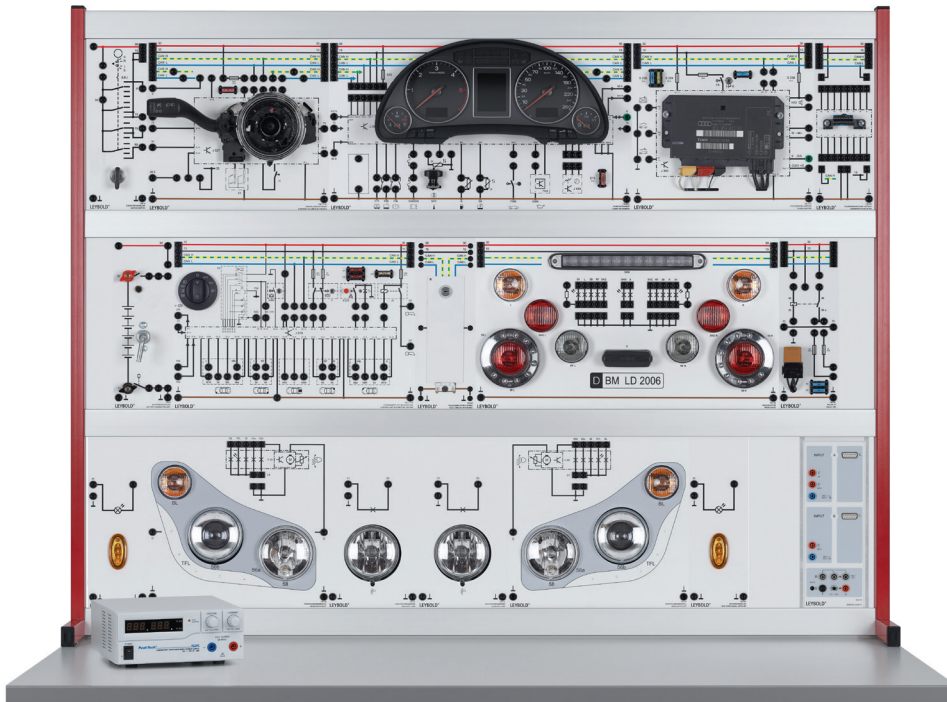
Éclairage automobile avec le bus CAN (A2.1.3.1)
