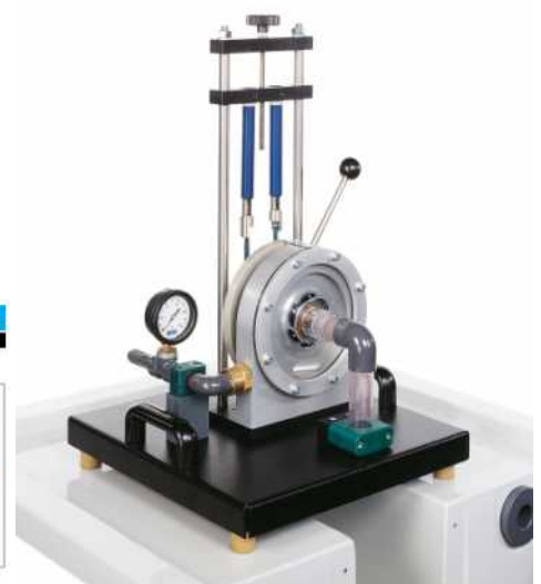
HM 150.20 PRINCIPLE DE FONCTIONNEMENT D'UNE TURBINE FRANCIS
