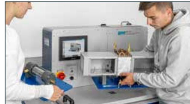
2. Retirer l'accessoire et le remettre en place sans outils, positionner l'échangeur de chaleur tube à ailettes sur la surface de travail de l'unité d'alimentation.
