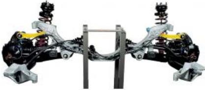
L'essieu est entièrement assemblé : Support d'essieu, double bras transversal, arbres d'essieu, disques de frein ventilés, freins à disque à 4 pistons, ressorts et amortisseurs. La compression de l'essieu peut être facilement démontrée.
