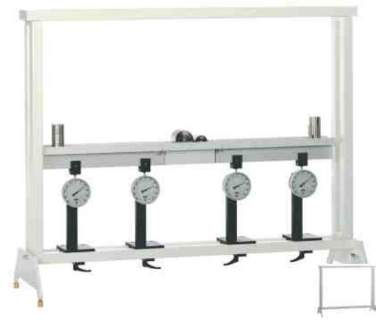
**SE 110.12 Forces au niveau d'un pont suspendu**
