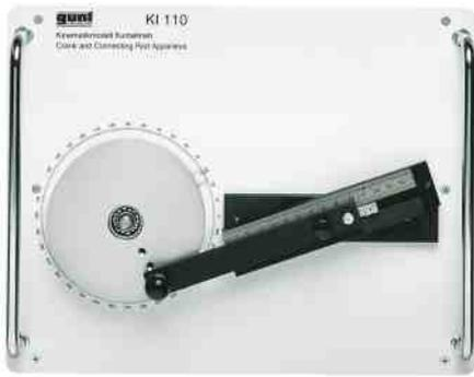
**KI 110 Modèle d'un système bielle-manivelle**
