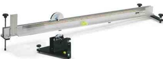
Détermination des inerties dans le mouvement de rotation par les méthodes du déroulement et du pendule.
