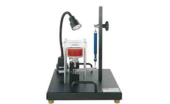
**TM 262 Appareil de démonstration de la pression hertzienne**
