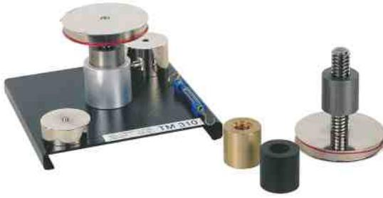
Rendement de filet de différents couples de matériaux et pas de filetage.
