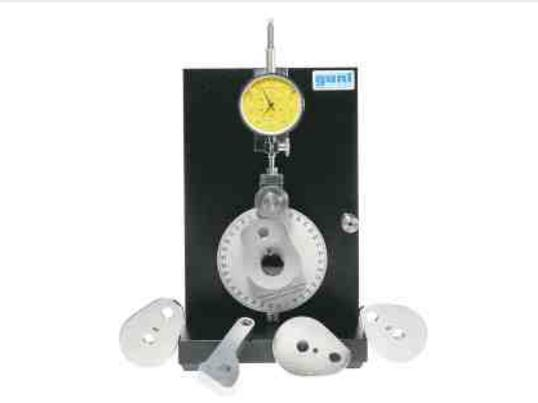
Démonstration et mesure de la courbe de levée de mécanisme à came.
