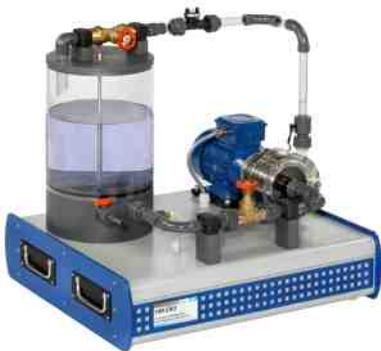
**HM 283 Essai sur une pompe centrifuge**
