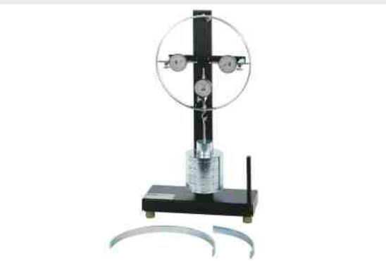
**FL 170 Déformation des poutres à axe courbe**
