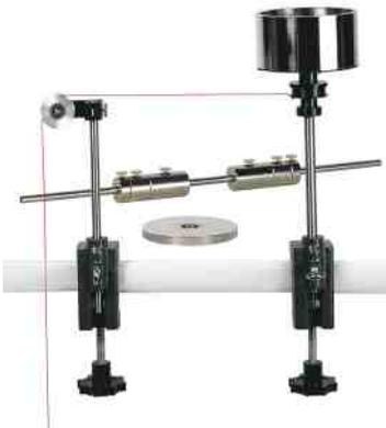
Détermination des moments d'inertie selon la disposition des masses et les différents corps.
