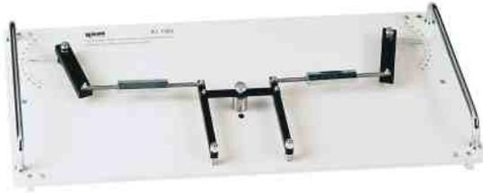
Détermination de l'angle d'avance d'un trapèze de direction.
