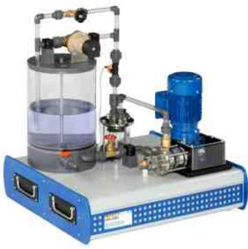
**HM 285 Essai sur une pompe à piston**
