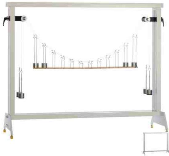
**SE 110.18 Forces au niveau d'un pont suspendu**
