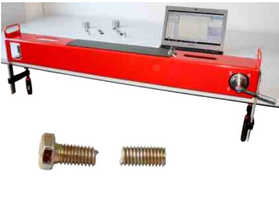
**EWTCO74177 Mesure du couple de serrage, de l'allongement jusqu'a la rupture.**
