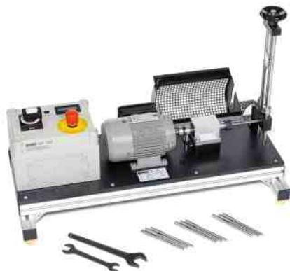
**WP 140 Machine d'essai de fatigue**
