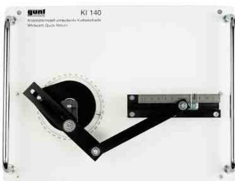
**KI 140 Modèle du mécanisme de Whitworth**
