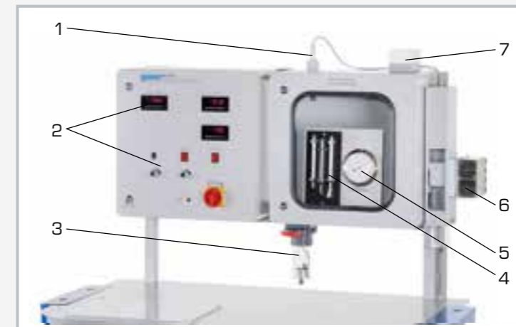
1 capteur d'humidité capacitif, 2 éléments d'affichage et de commande, 3 humidificateur, 4 psychromètre, 5 hygromètre à cheveu, 6 déshumidificateur, 7 hygromètre à fibres synthétiques et capteur de température combiné
