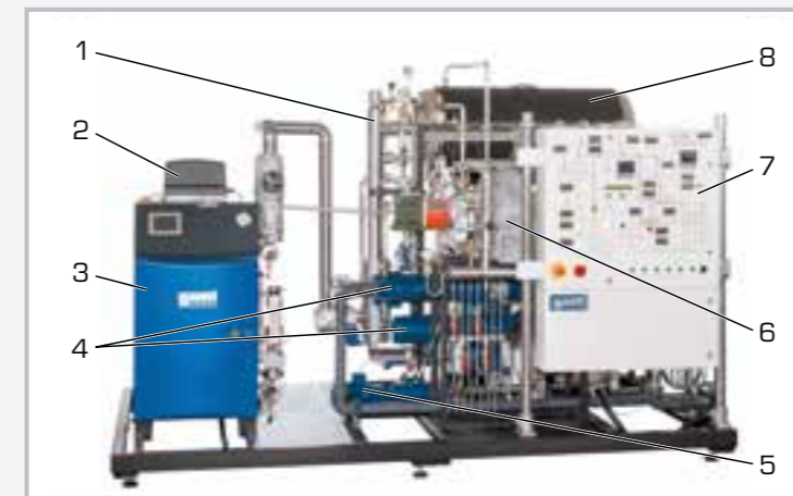
1 surchauffeur, 2 brûleur, 3 chaudière, 4 condensateur, 5 pompe de condensat, 6 turbine, 7 éléments d'affichage et de commande, 8 réservoir d'eau d'alimentation avec traitement de l'eau d'alimentation
