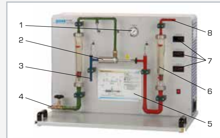
1 manomètre, 2 tube à vortex, 3 sortie d'air froid, 4 raccord d'air comprimé, 5 schéma de processus, 6 débitmètre, 7 affichages de température, 8 sortie d'air chaud
