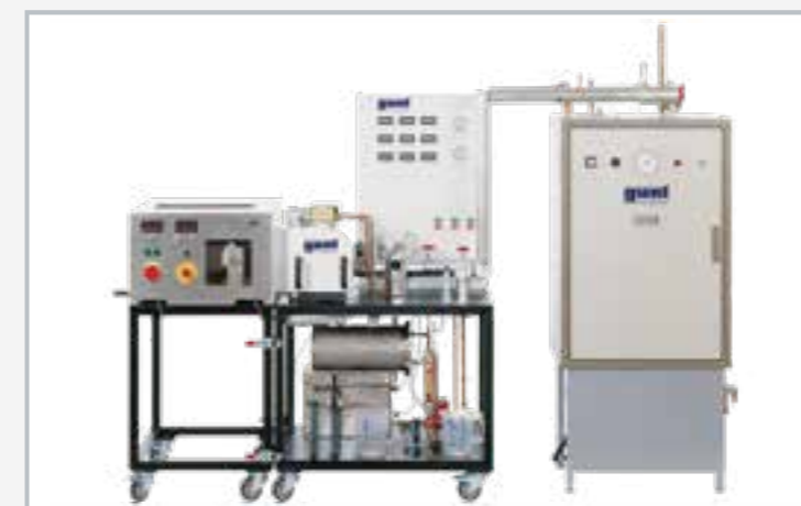
Montage expérimental prêt à fonctionner: à gauche: dispositif de freinage HM 365, au milieu: machine à vapeur deux cylindres ET 813, à droite: générateur de vapeur ET 813.01
