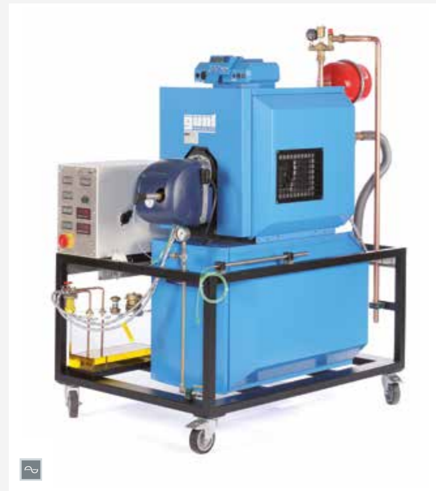
L'illustration montre le banc d'essai avec l'accessoire HL 352.01 Brûleur à fioul
