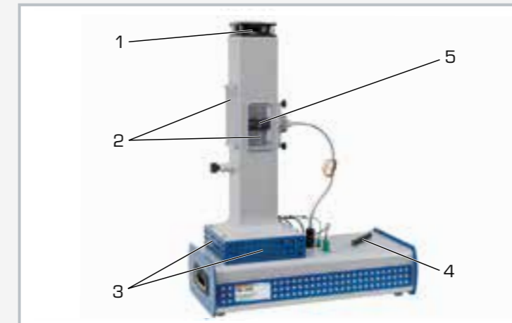
1 ventilateur, 2 voyant, 3 entrée d'air, 4 instrument portable de mesure de température, 5 élément de chauffage
