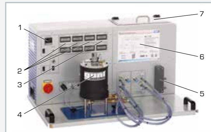
1 régulateur de température, 2 affichages de la température, 3 affichages du débit, 4 réservoir agitateur avec double enveloppe et serpentin WL 110.04, 5 raccords de circuit d'eau froide, 6 schéma de processus, 7 réservoir d'eau chaude
