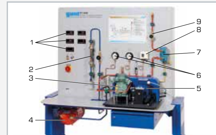
1 éléments d'affichage et de commande, 2 débitmètre, 3 compresseur de l'agent réfrigérant, 4 réservoir de stabilisation, 5 moteur d'entraînement avec mesure du couple, 6 manomètre, 7 séparateur d'huile, 8 pressostat, 9 vanne
