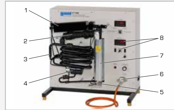
1 condenseur, 2 évaporateur avec chauffage, 3 absorbeur, 4 réservoir, 5 brûleur à gaz, 6 soupape de réduction de pression pour le fonctionnement avec propane, 7 bouilleur avec pompe pour bulles de vapeur pour l'éjection de l'ammoniac, 8 éléments d'affichage et de commande
