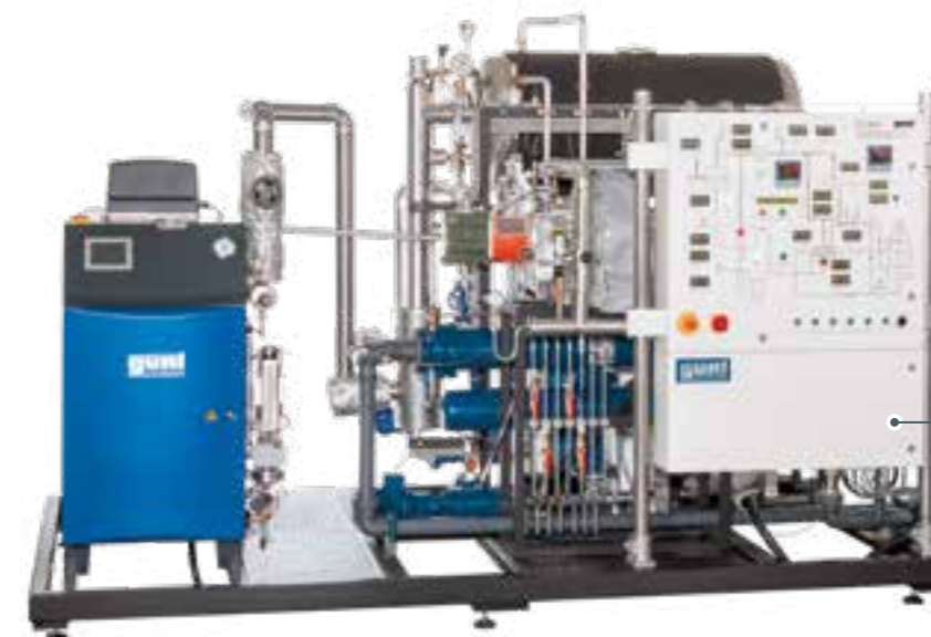
Module B Groupe de turbine à vapeur
