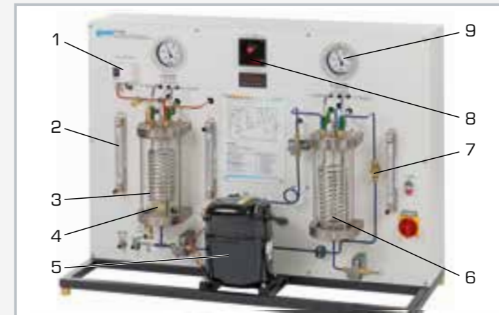
1 pressostat, 2 débitmètre, 3 condenseur, 4 soupape de détente, 5 compresseur, 6 évaporateur, 7 voyant, 8 affichage de température, 9 manomètre
