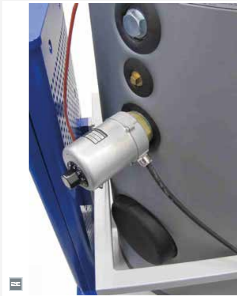
Dispositif de chauffage HL 320.02 monté dans un réservoir bivalent du HL 320.05
