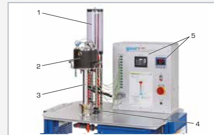
1 réservoir élevé pour pression d'admission constante de l'eau de refroidissement, 2 source de chaleur avec dispositif de chauffage, 3 éprouvette, 4 dissipateur thermique refroidi par eau, 5 éléments d'affichage et de commande
