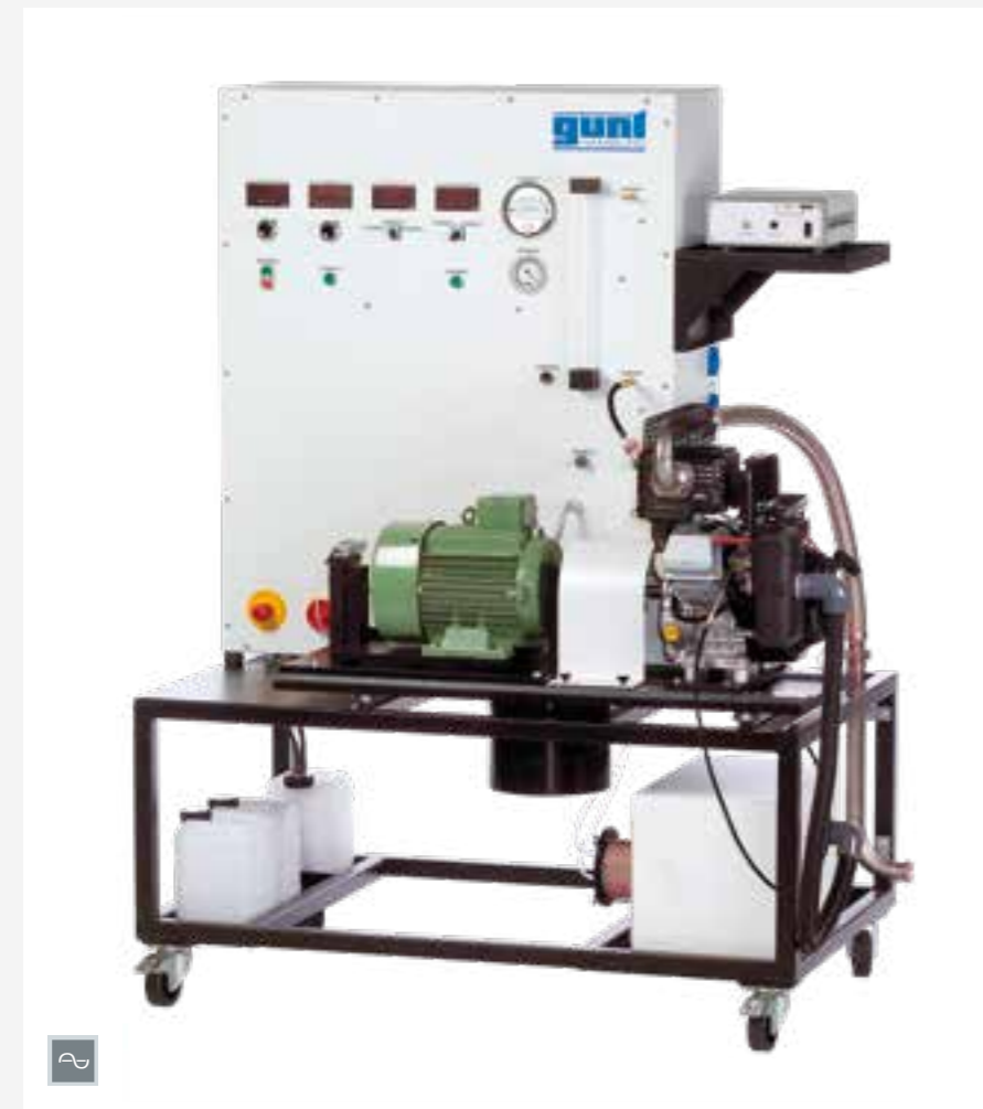
L'illustration montre le CT 110 avec le moteur CT 100.20 et le système d'indication électronique CT 100.13 (sur le support).
