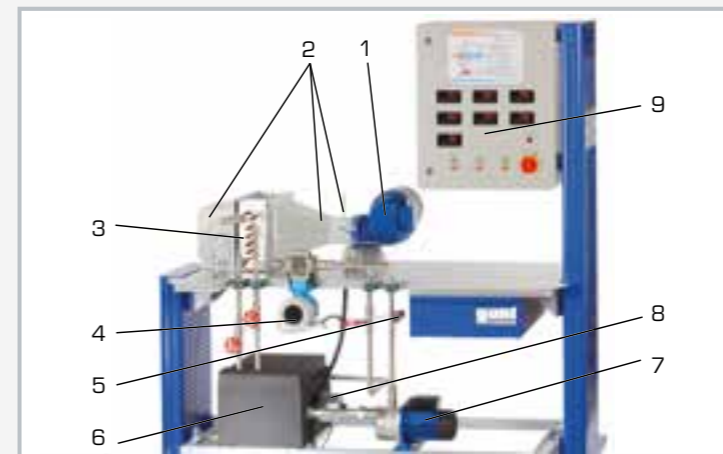
1 ventilateur, 2 conduit d'air avec points de mesure de la température, 3 échangeur de chaleur, 4 débitmètre, 5 capteur de pression, 6 réservoir d'eau, 7 pompe, 8 dispositif de chauffage avec thermostat, 9 éléments d'affichage et de commande
