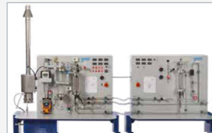
À gauche, le générateur de vapeur ET 850 et à droite, la turbine à vapeur axiale ET 851; une fois montés et prêts à fonctionner, ils forment ensemble une centrale thermique à vapeur complète
