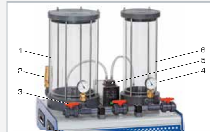
1 réservoir en surpression, 2 soupape de sécurité, 3 robinet à tournant sphérique, 4 manomètre, 5 compresseur, 6 réservoir en dépression
