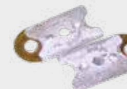
Élément de déclenchement avec brasure fondue
