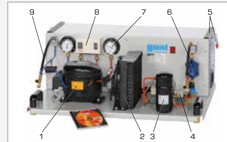
1 compresseur, 2 condenseur avec ventilateur enclenchable, 3 réservoir, 4 électrovanne, 5 cadre pour accueil du modèle, 6 filtre/sécheur, 7 manomètre, 8 pressostat, 9 flexible d'agent réfrigérant
