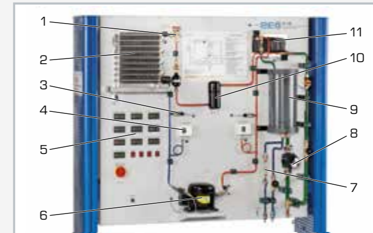
1 soupape de détente, 2 condenseur avec ventilation, 3 capteur de pression, 4 pressostat, 5 éléments d'affichage et de commande, 6 compresseur, 7 débitmètre eau de refroidissement, 8 pompe, 9 réservoir d'eau chaude, 10 réservoir, 11 condenseur
