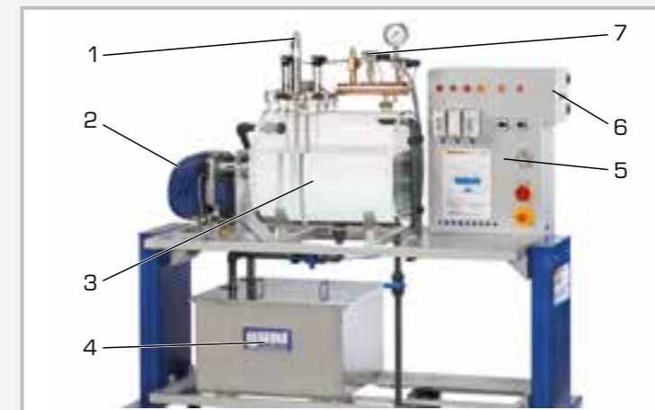
1 surveillance du niveau d'eau, 2 brûleur, 3 modèle de chaudière à vapeur, 4 réservoir d'alimentation, 5 armoire de commande, 6 coffret de commande pour des pannes, 7 dispositifs de mesure de la pression
