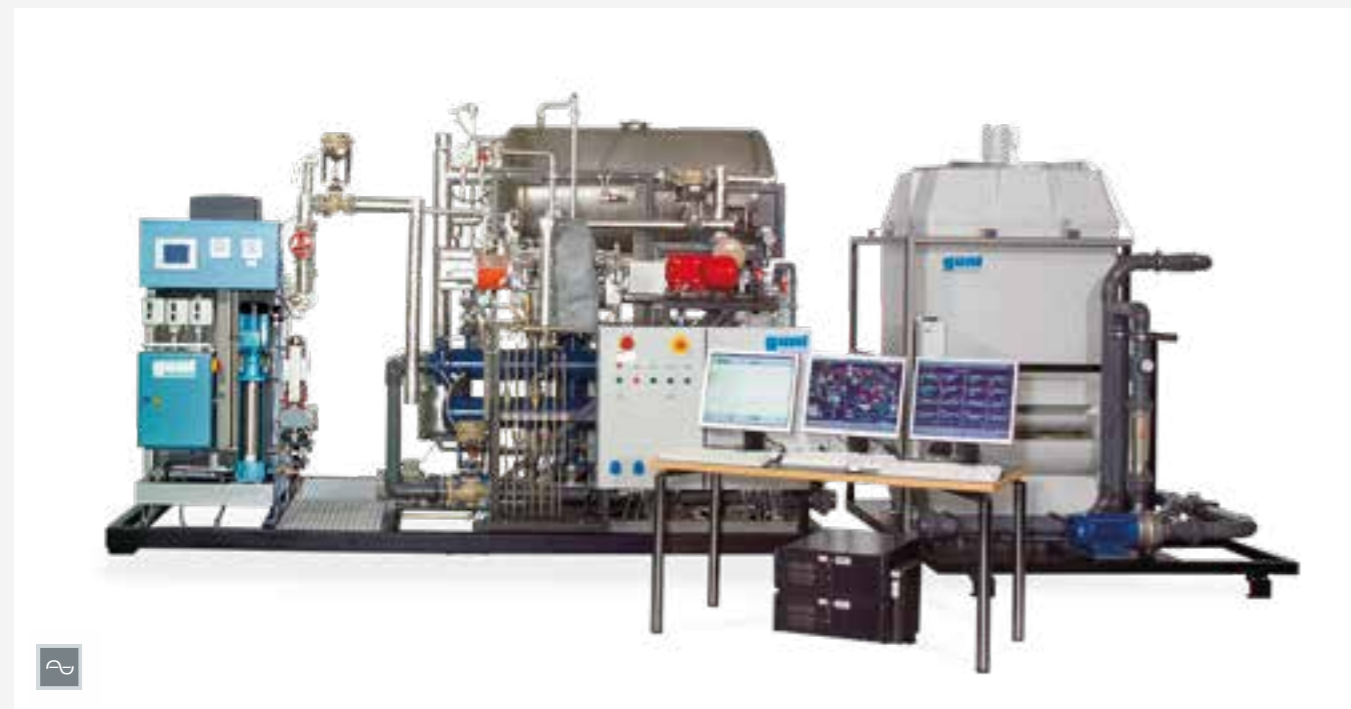
L'illustration montre la centrale thermique à vapeur avec la tour de refroidissement ET 833.01.
