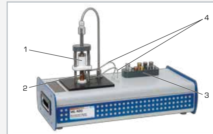
1 dispositif de chauffage, 2 éprouvette, 3 rangement pour éprouvettes, 4 thermocouple; élément Peltier caché
