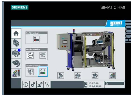
Activer le mode de formation sur l'écran tactile. Le compteur d'heures de fonctionnement est situé dans l'API. Les intervalles d'entretien des différents sous-systèmes peuvent être simulés, c'est-à-dire ajustés.
