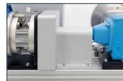
protection mécanique, arbre d'entraînement/accouplement, côté entraînement
