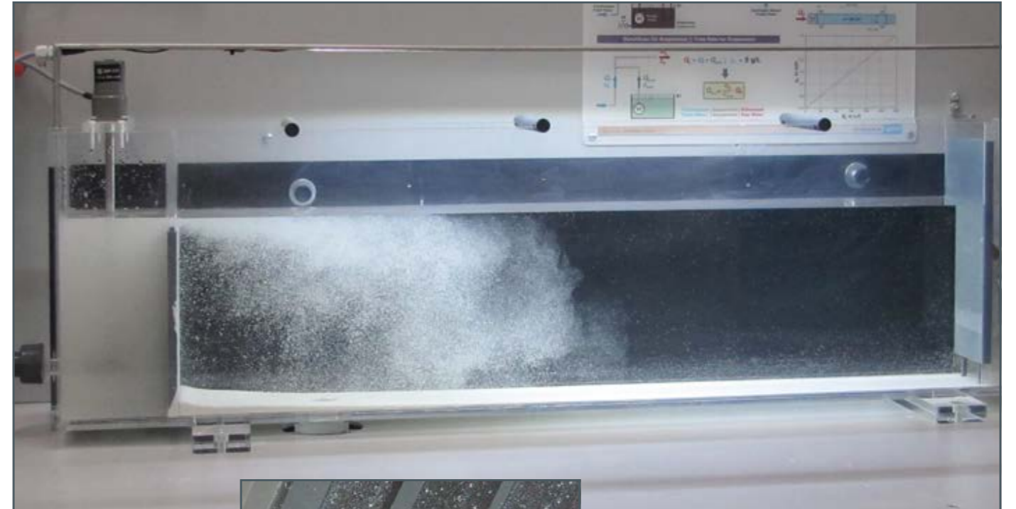
L'utilisation de matériaux transparents et d'un éclairage permettent une observation optimale du processus de sédimentation et des conditions d'écoulement.
