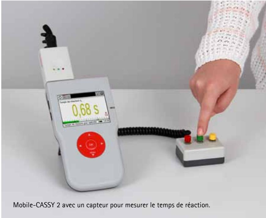
Mobile-CASSY 2 avec un capteur pour mesurer le temps de réaction.
