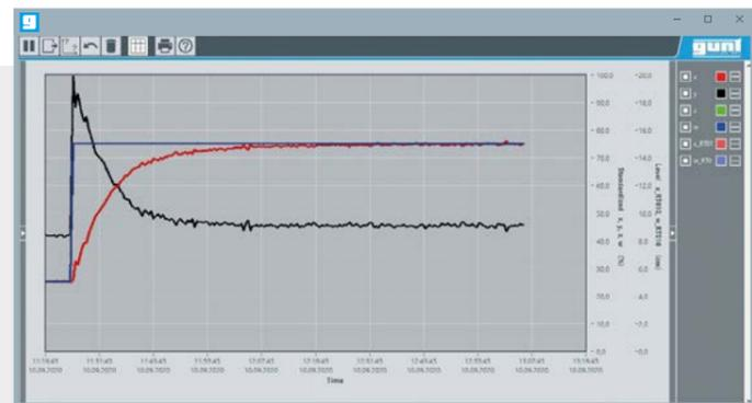
Régulation de niveau avec régulateur PID, échelon de grandeur de référence
