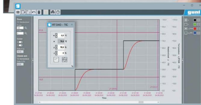
La fonction de simulation du logiciel GUNT peut également être utilisée pour étudier des questions de technique de régulation pour lesquelles aucun système réel n'est disponible.
