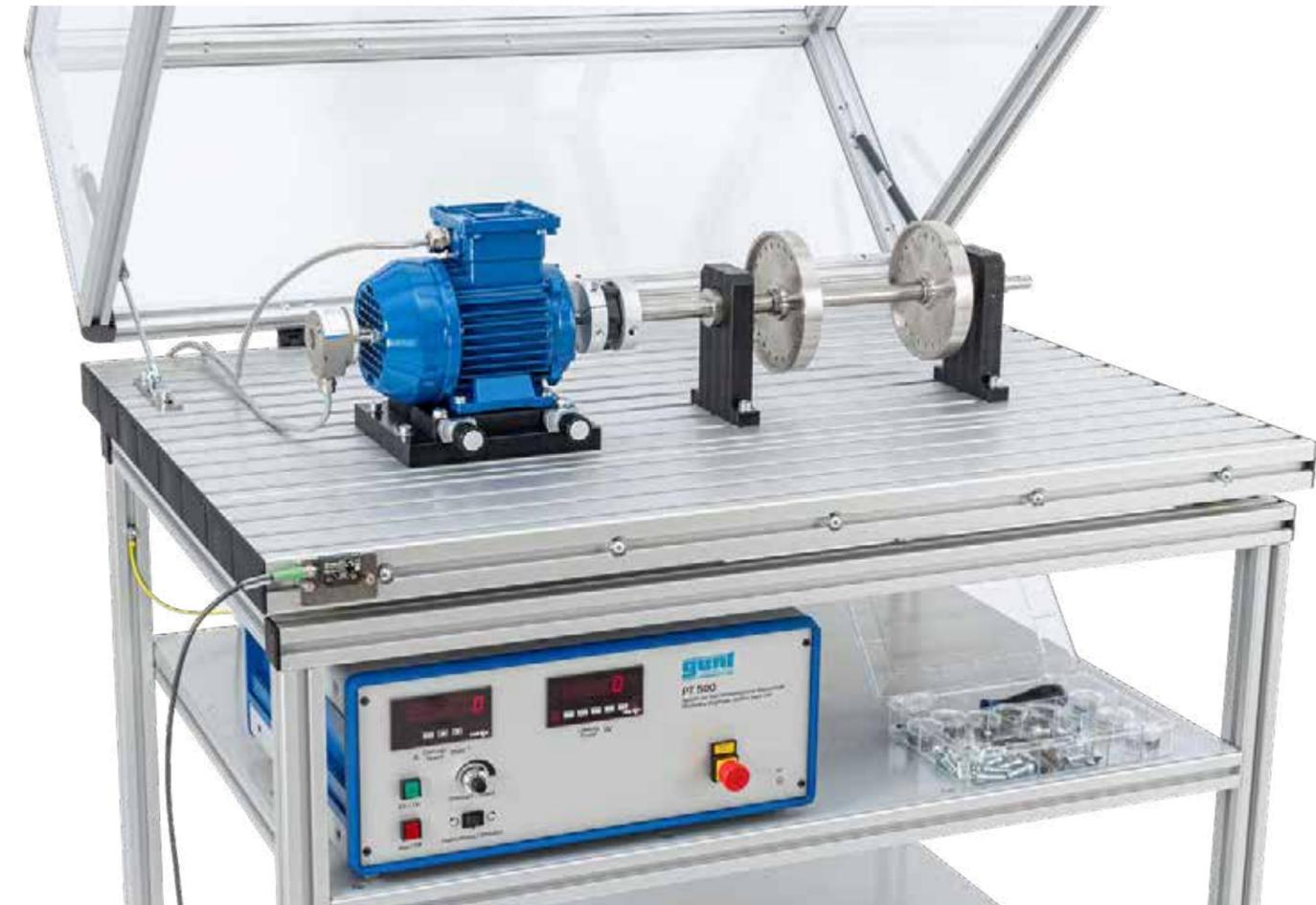
L'appareil de base comprend un support de fixation à faibles vibrations, un moteur d'entraînement à régulation de vitesse de rotation avec tachymètre, un arbre avec deux volants et deux paliers, un accouple-
