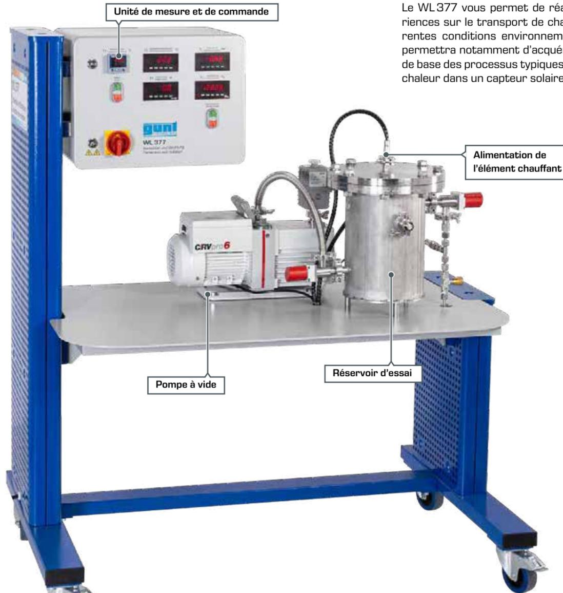
Le WL 377 vous permet de réaliser des expériences sur le transport de chaleur dans différentes conditions environnementales. Il vous permettra notamment d'acquérir les principes de base des processus typiques de transfert de chaleur dans un capteur solaire thermique.
