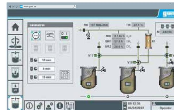
Dans le menu **Analyse de gaz** de l'interface utilisateur de l'API, vous obtenez un aperçu de la direction d'écoulement actuelle du gaz ainsi que les valeurs de mesure actuelles de l'analyse de gaz. Ce menu vous permet également de choisir entre les modes de mesure **Auto** ou **Manuel**, avec les temps de mesure pour chaque réservoir. Ce menu vous permet aussi d'appeler les courbes des valeurs de mesure enregistrées.
