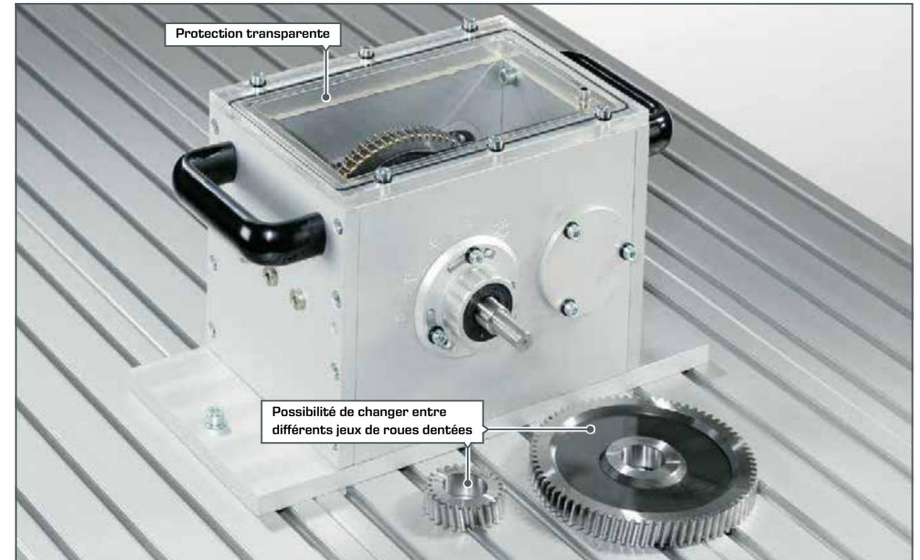
Le jeu d'accessoires PT 500.15 vous permet de disposer de différents jeux de roues avec différents dommages des dents. Des roues non endommagées sont également incluses à la liste de livraison pour permettre des mesures comparatives. PT 500.15
