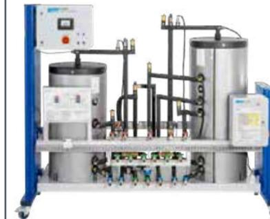
Le module de stockage est composé d'un réservoir bivalent et d'un réservoir tampon. Le régulateur permet d'enregistrer, même sur des périodes longues, les valeurs de mesure requises pour l'analyse du comportement du système.
