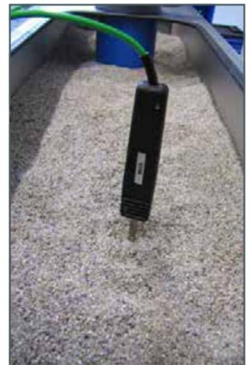
Mesures de température avec une sonde manuelle
