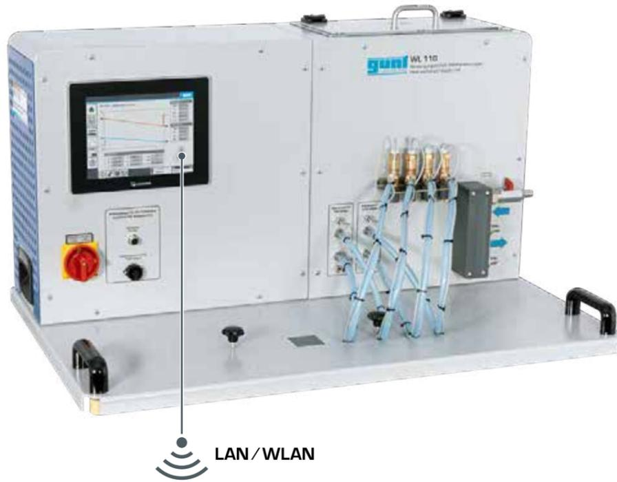
Connexion à 10 terminaux mobiles via un routeur WLAN intégré
