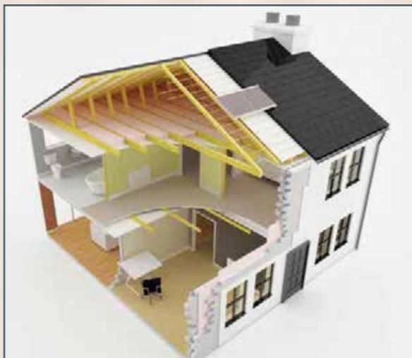
L'isolation thermique des murs et du toit représente un moyen parmi d'autres pour économiser de l'énergie dans les bâtiments. Pour évaluer la rentabilité, il convient dans chaque cas de réaliser une analyse des économies attendues par cette réduction des déperditions thermiques.
