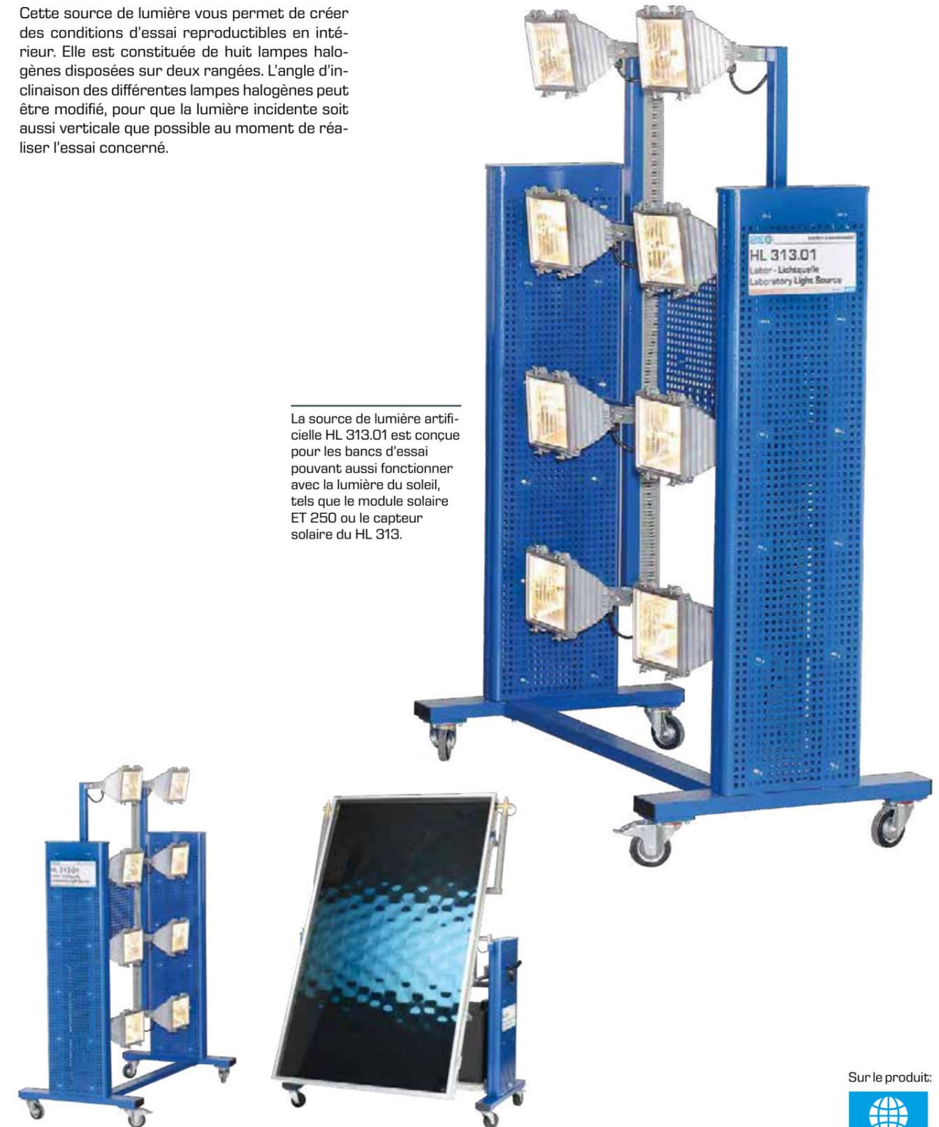
La source de lumière artificielle HL 313.01 avec le capteur plan HL 313
