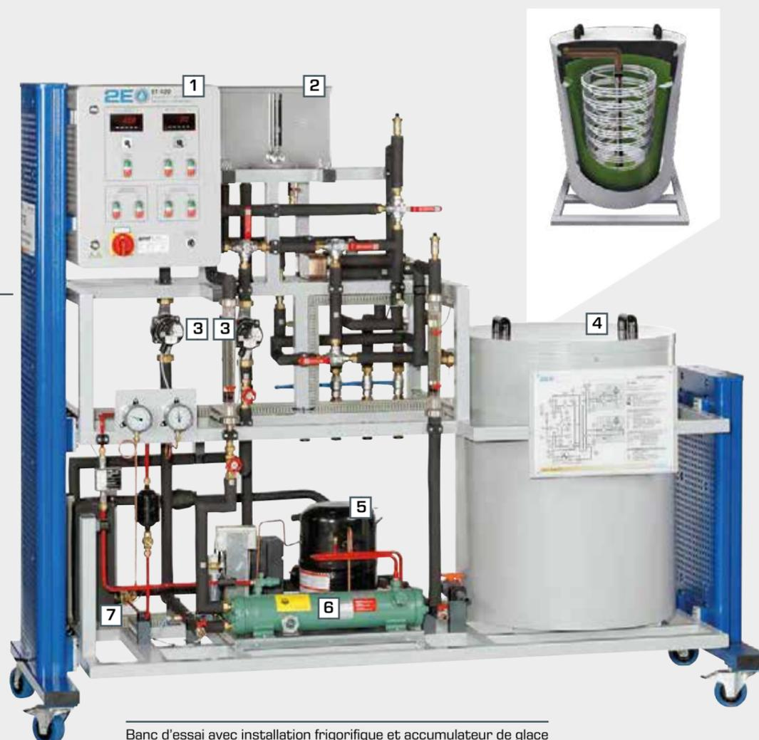
Banc d'essai avec installation frigorifique et accumulateur de glace
