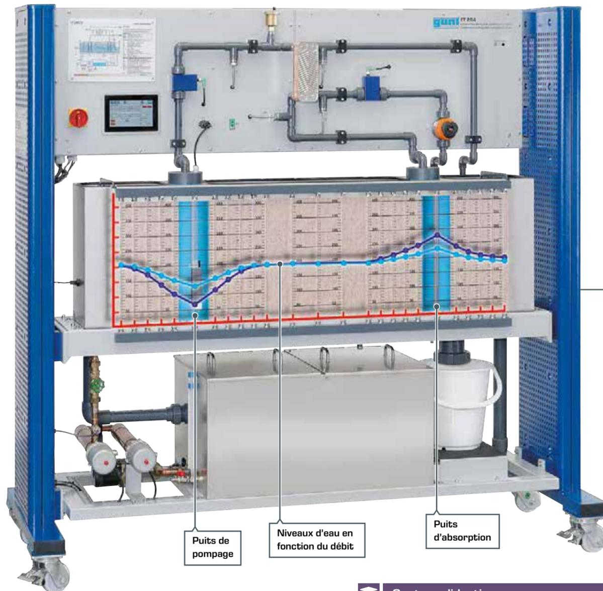
L'élément central du banc d'essai est un lit de sable traversé par de l'eau, avec un puits d'alimentation et un puits d'absorption. L'écoulement souterrain simulé peut entrer et sortir du lit de sable par deux chambres adjacentes sur les côtés, avec une hauteur de remplissage ajustable. L'alimentation est assurée par un circuit d'eau chauffé avec un réservoir de stockage et une pompe.
