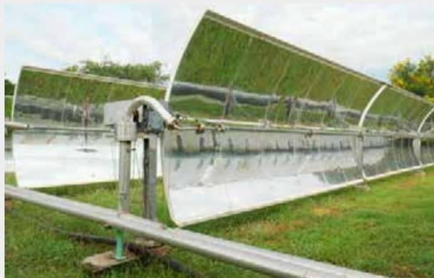
Pour une centrale électrique, les capteurs cylindro-paraboliques individuels peuvent être reliés entre eux pour former un champ de capteurs.
