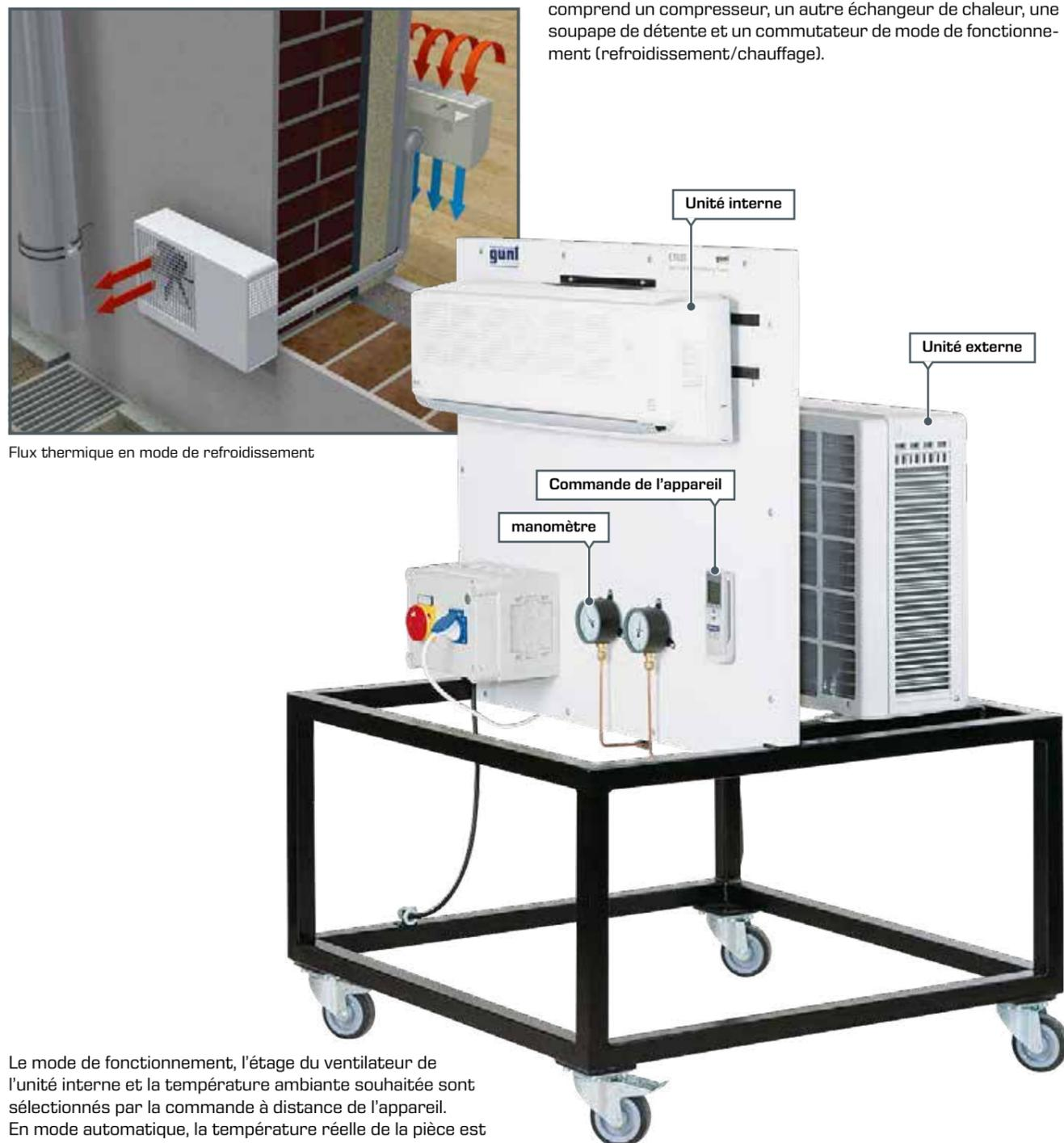
Flux thermique en mode de refroidissement
