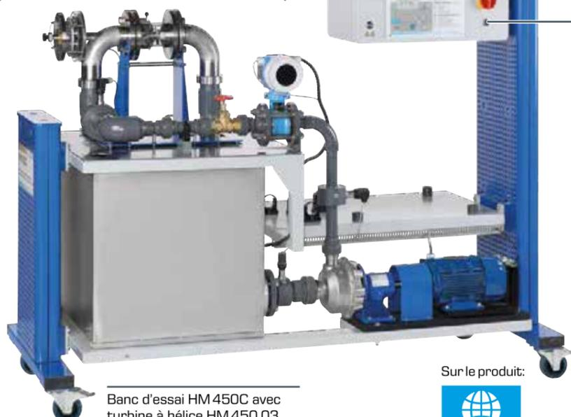
Banc d'essai HM 450C avec turbine à hélice HM 450.03
