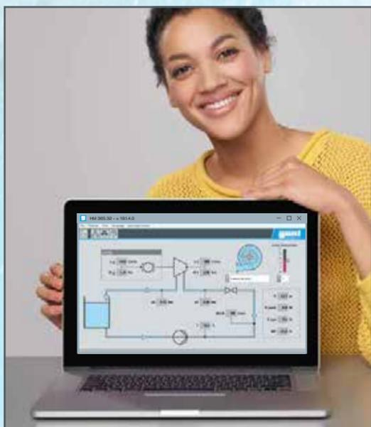
Le logiciel GUNT offre une visualisation intuitive des données de mesure actuelles sur un schéma d'installation et permet l'acquisition continue des données via un raccordement USB. Bien entendu, des représentations graphiques et des calculs sont également prévus pour analyser les données de mesure.
