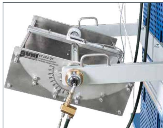
capteur cylindro-parabolique pivotant
