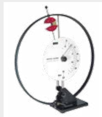
L'appareil d'essai compact WP 400 génère une capacité de travail de 25 Nm
