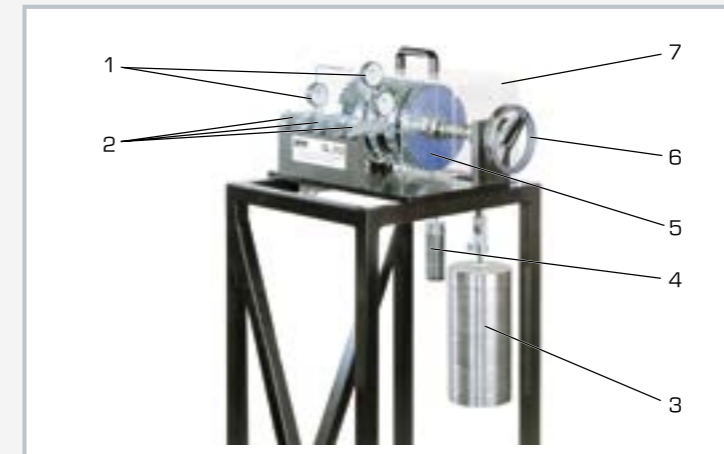
1 horloge de mesure, 2 capteur de flexion, 3 jeu de poids, 4 jeu de poids pour la mesure des rapports de transmission, 5 engrenage planétaire, 6 manivelle manuelle, 7 capot de protection
