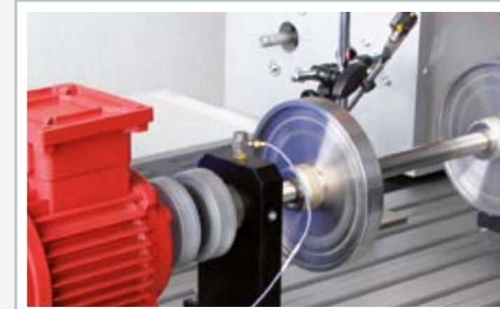
Capteurs montés: capteur d'accélération sur le support noir, capteur de vitesse avec support
