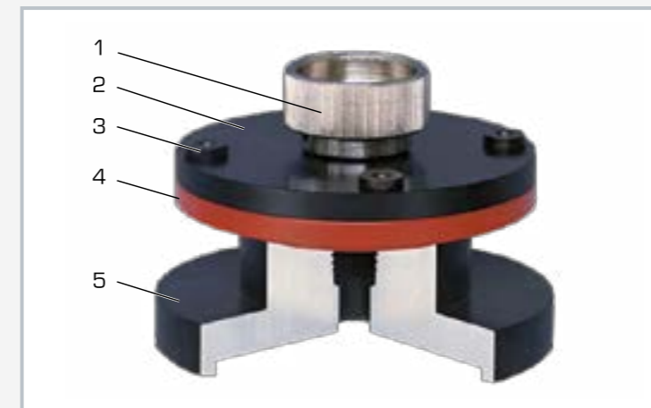
Dispositif de perçage monté avec pièce à usiner: 1 vis de fixation, 2 plaque de perçage, 3 canon de perçage, 4 pièce à usiner (chapeau de palier), 5 corps de base
