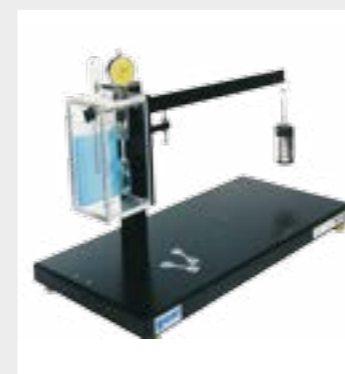
L'appareil d'essai compact WP 600 permet de réaliser des essais de fluage
