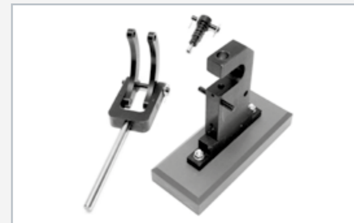
Groupes fonctionnels de la presse à bras: fourche, boulon de pression, corps de base
