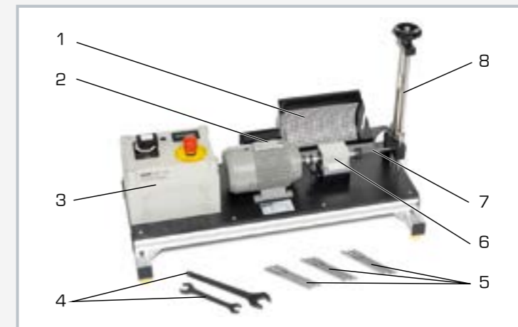
1 capot de protection, 2 moteur électrique, 3 coffret de commande, 4 outil, 5 éprouvettes, 6 palier, 7 éprouvette maintenue, 8 dispositif de charge avec balance à ressort et roue à main
