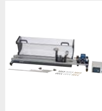
L'appareil d'essai compact WP 500 génère des moments d'essai de 30 Nm
