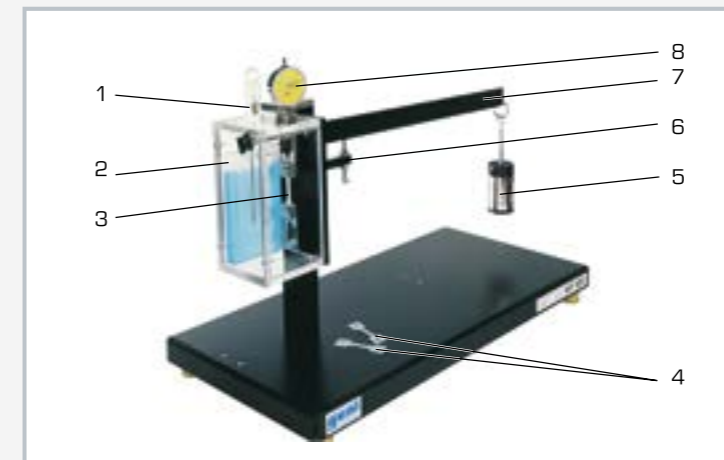
1 thermomètre pour boîte de température, 2 accumulateur pour le refroidissement de l'éprouvette, 3 éprouvette maintenue, 4 éprouvettes, 5 poids, 6 butée mobile pour le levier, 7 levier, 8 comparateur à cadran
