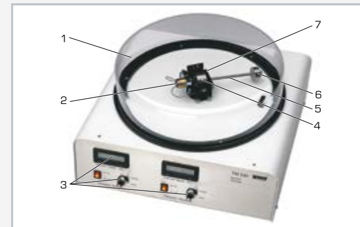
1 capot de protection, 2 moteur d'entraînement de la toupie, 3 affichage et ajustage de la vitesse de rotation de l'axe de rotation horizontal de la toupie et de l'axe vertical de précession, 4 masse d'inertie de la toupie, 5 levier, 6 poids mobile, 7 châssis intérieur
