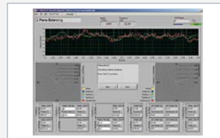
Équilibrage sur deux plans à l'aide du logiciel GUNT d'analyse des vibrations
