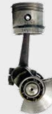
Exemple de forces oscillantes et rotatives dues à la masse: le piston alternatif
