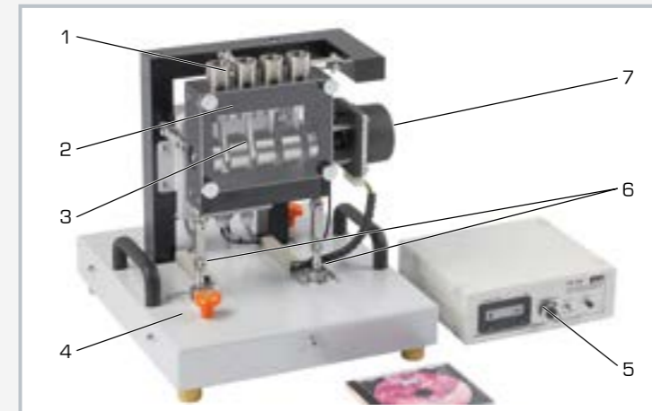
1 cylindre, 2 piston, 3 angle de calage des manivelles, 4 plaque de fondation, 5 appareil d'affichage et de commande, 6 capteur de force, 7 moteur d'entraînement
