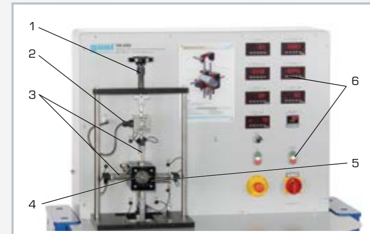
1 roue à main pour charge, 2 capteur de force pour couple de frottement, 3 capteurs de déplacement inductifs, 4 arbre, 5 logement de palier, 6 éléments d'affichage et de commande
