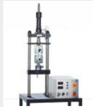
Le banc d'essai WP 310 génère une force d'essai de 50 kN
