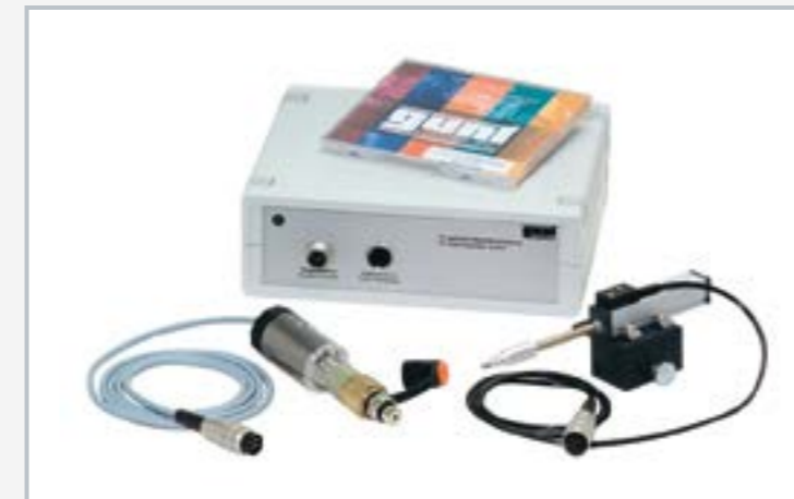
Système d'acquisition de données entièrement monté avec le CD du logiciel Au premier plan: à gauche: capteur de pression, à droite: capteur de déplacement
