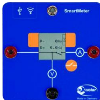
Wattmètre mesure de la puissance W et de l'énergie Wh.
