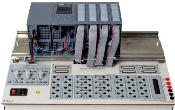
Platine avec API SIEMENS câblé.
