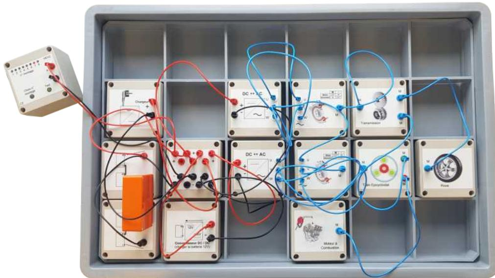
Exemple du montage n°7 combiné (série et parallèle) plug in, câblé.
