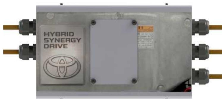
Simulation du convertisseur DC / AC, avec 5 câbles oranges et une trappe démontable pour la vérification d'absence de tension, situé dans le compartiment moteur.
