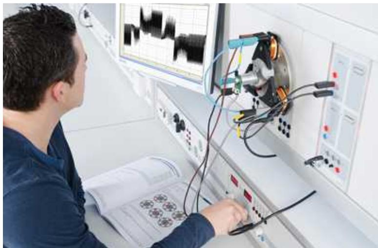
Différents types de Stator : aimant permanent ou bobiné
