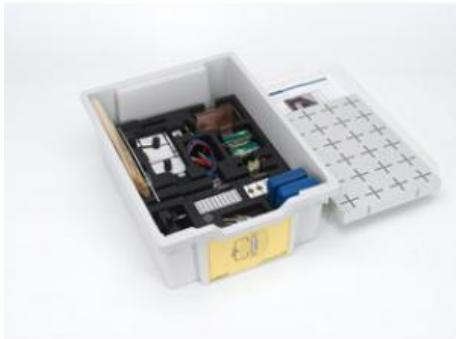
Équipement pour la réalisation d'expériences fondamentales en électricité, par ex. pour l'étude des thèmes suivants : circuit électrique, loi d'Ohm, diode, aimants, induction, conductivité, influence ; dans boîte en plastique avec couvercle et insert thermoformé à la forme des composants.
