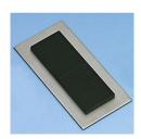
Pour l'observation et l'étude quantitative de l'interférence de la lumière après réflexion sur deux miroirs. À angle d'inclinaison fixe ; sur plaque pour la fixation au support pour diaphragmes et diapositives ( 459 33 ).
