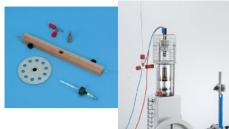
Pour la détermination quantitative du bilan des puissances, du freinage mécanique, de la mesure sans contact de la vitesse de rotation, de la mesure du débit et de la température du flux d'eau de refroidissement ainsi que pour la compensation électrique de la puissance frigorifique. À utiliser avec le moteur à air chauti. 388 182.
