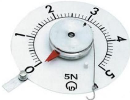
**Dynamomètre 5 N, pied aimanté pour le tableau magnétique**
