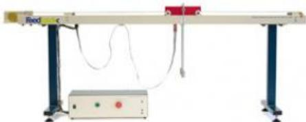
Le pendule numérique est une version moderne d'un problème de contrôle classique: le redressement et la stabilité d'un pendule à oscillation libre (pendule inversé) ou le contrôle de mouvement d'un pendule suspendu (application pour MATLAB, avec carte d'interface MATLAB et câbles)
