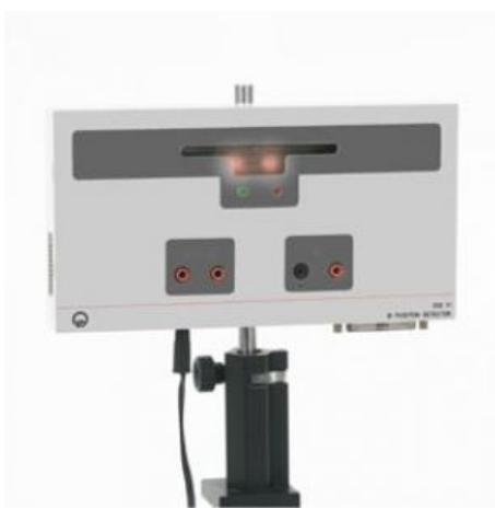
Appareil de mesure opto-électronique pour l'enregistrement des oscillations de balances de gravitation.
