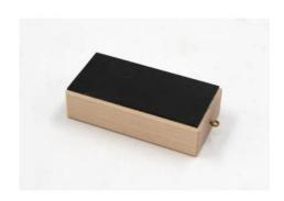
Bloc de bois pour les essais de frottement. Avec crochet latéral pour fixer un dynamomètre. Le frottement de glissement et d'adhérence de deux matériaux (bois, caoutchouc) peut être comparé. En outre, il est possible d'étudier l'influence en présence de surfaces de tailles différentes (bois).
