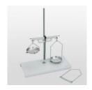
Convient particulièrement pour la détermination de la densité, la démonstration du principe d'Archimède et le pesage de l'air contenu dans une sphère à 2 robinets (37907).
