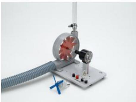
**Modèle centrale hydroélectrique (étude d'une turbine Pelton)**
