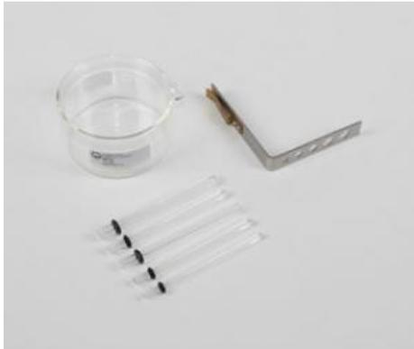
Pour mettre en évidence les forces de capillarité et déterminer la tension superficielle des liquides selon la méthode de la montée capillaire.
