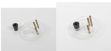
Composé d'un couvercle transparent avec possibilité de monter un filament chauffant (38422) ou un porte-échantillon (38423).
