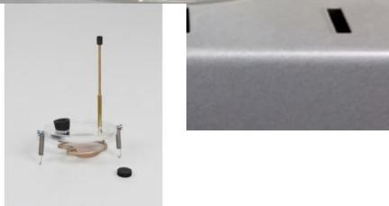
Avec un bouchon en caoutchouc percé pour le passage d'un thermomètre et du porte-échantillon
