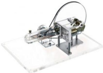
Pour l'étude expérimentale et les mesures dun cycle thermodynamique (cycle de Stirling).
