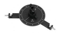
Pour relier deux bancs d'optique à profil normalisé, pourvue d'une colonne pivotante permettant le logement d'un composant optique. Mise en place possible d'un capteur de rotation S (524 082) pour mesurer l'angle formé par les rails.
