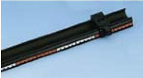
Banc d'optique pour démonstration et travaux pratiques.
