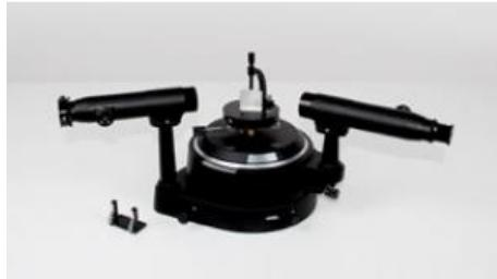
Pour observer et mesurer les spectres d'absorption et d'émission.
