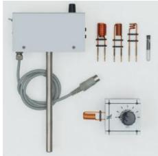
Pour la réalisation d'expériences sur la résonance de spin électronique en association avec l'alimentation RSE ( 514571 ) ou avec l'adaptateur RSE ( 51456 ).
