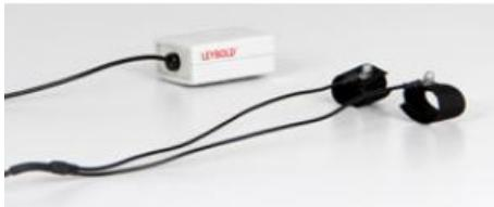
Pour mesurer la conductivité électrique de la peau avec CASSY et ainsi évaluer l'excitation émotionnelle (le stress) du sujet expérimental et les réactions stéréotypées au stress. Les électrodes se fixent au bout des doigts avec des bandes Velcro et sont isolées galvaniquement de CASSY.
