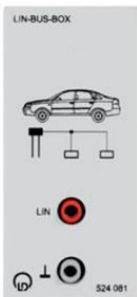
Se branche à un bus LIN pour le relevé et l'exploitation du signal du message avec un oscilloscope - avec possibilité de déclenchement sur un identificateur librement sélectionnable - et l'analyse simultanée du protocole.
