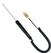
Thermocouple NiCr-Ni avec connecteur miniature pour la mesure de la haute température dans les liquides et les gaz, avec poignée et câble spiralé. S'utilise avec CASSY, combiné au connecteur adaptateur NiCr-Ni S (524 0673), ou directement avec l'adaptateur chimie (524 067) et le Mobile CASSY 2 (524 005).
