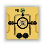
Composant avec 5 douilles de sécurité pour le raccordement des conducteurs extérieur, neutre et de protection et avec 2 douilles de sécurité sur le boîtier pour la simulation d'un court-circuit à la masse. Avec ampoule 12V/6W (50522ET5). S?utilise sur le tableau magnétique (301301).
