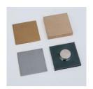
Utilisées avec le détecteur d'énergie de rayonnement X ( 559 938 ), le Sensor-CASSY ( 524 013 ) et l'adaptateur AMC ( 524 058 ), les cibles permettent de relever les spectres de fluorescence X de différents alliages dans l'appareil à rayons X ( 559 801 ).
