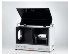
Permet de reconstruire en quelques minutes la géométrie tridimensionnelle d'un objet à partir de la façon dont les rayons traversant celui-ci sont absorbés suivant leurs angles de pénétration.
