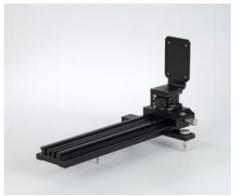
Pour le positionnement et l'ajustage précis du capteur pour radiographie ( 554828 ) dans l'appareil à rayons X ( 554800 ou 55481 ).
