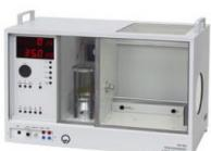
Appareil de base, ajusté et prêt à l'emploi pour tous les tubes Molybdène( 554 861 ) Cuivre( 554 862 ) Fer( 554 863 ) Tungstène( 554 864 ) Argent( 554 865 ), mais livré sans tube et sans goniomètre ( 554 831 ).
