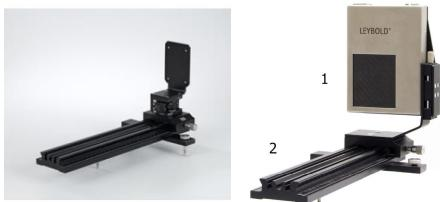
Pour le positionnement et l'ajustage précis du capteur pour radiographie ( 554828 ) dans l'appareil à rayons X ( 554800 ou 55481 ).
