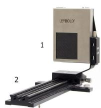
Capteur d'image compacte à haute résolution avec connexion Ethernet pour la prise directe de radiographies dans un appareil à rayons X sous des conditions d'éclairage naturel (sans film radiographique ou écran luminescent).
