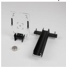
Pour l'appareil à rayons X ( 554 800 et 554 801 ), avec échelle sériographiée pour le positionnement défini des films pour les radiosopies, les clichés de Laue et de Debye-Scherrer ; livré avec rail d'expérimentation à échelle graduée en millimètres et diaphragme à trou (D = 1 mm) à placer sur le collimateur à fente.
