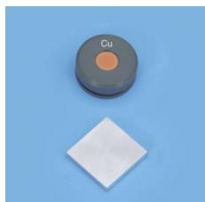
Pour l'appareil à rayons X (554 801) pour l'étude de l'effet Compton par transmission en fonction de la longueur d'onde, suivant le positionnement du filtre Cu devant ou derrière le diffuseur en aluminium avec corps dispersant en aluminium et filtre en cuivre dans monture.
