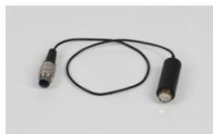
Tube compteur Geiger-Müller à auto-extinction, dans boîtier en plastique, avec fenêtre en mica très mince permettant aussi l'enregistrement d'un rayonnement  $\beta$  mou. Muni d'un câble solidaire. Livré avec capuchon de protection pour la fenêtre en mica.
